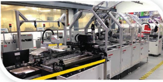
賀卡柔性生產線貫徹了「柔性生產製造單元」的概念，模組式的結構設計方便於生產工藝上的增減和更換，該機採用的計算機輔助製造軟件 (CAM)，使換款時間縮短了75%。
