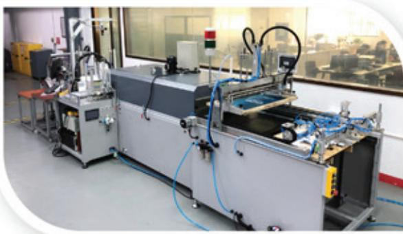
紙盒打膠貼輔料線採用了模組式結構設計，由自動絲印機、視覺機器人和產品流水線組成；完成在紙盒上絲印膠水、粘貼輔料等一系列動作；自動絲印機和視覺機器人可以根據生產需要移至其它產線上使用。
