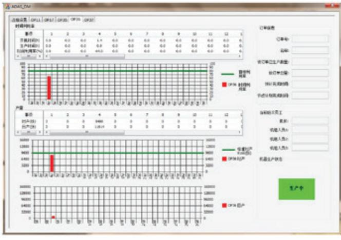
通過安裝數據自動收集系統，實現將印刷機設備生產數據遠距離傳輸至拉斯曼本地收集，數據實時更新，並且自動計算時間利用率，時產等重要指標。
